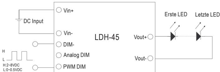
Während des PWM-Dimmvorgangs ändert sich Io mit dem PWM-Tastverhältnis (PWM-Signal: 1K~10KHz)
