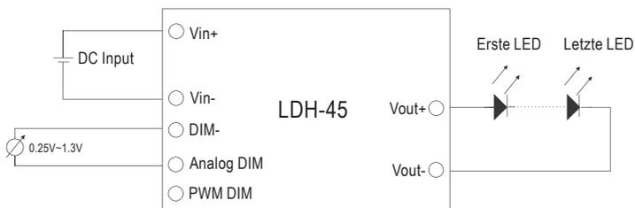
Im analogen Dimmbetrieb ändert sich Io mit der Eingangsgleichspannung
